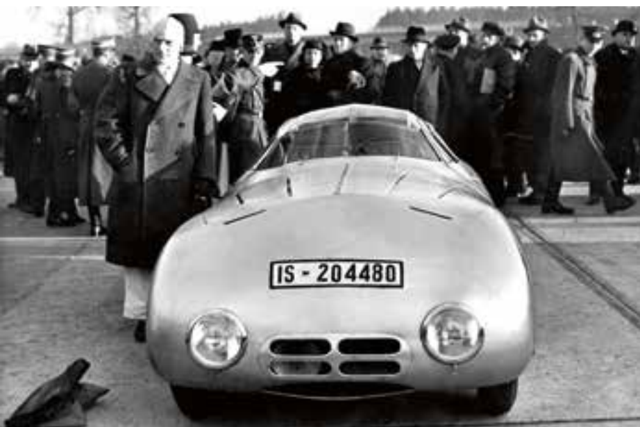
Ligero y afilado. Paul Jaray se ocupó de la línea aerodinámica de la carrocería. El piloto Haeberte apenas cabía en el estrecho y bajo puesto de conducción.
